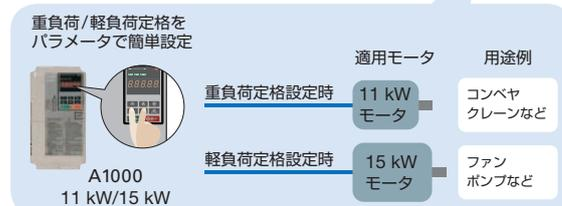
(注) インバータ定格出力電流がモータ定格電流以上となるように選定してください。
